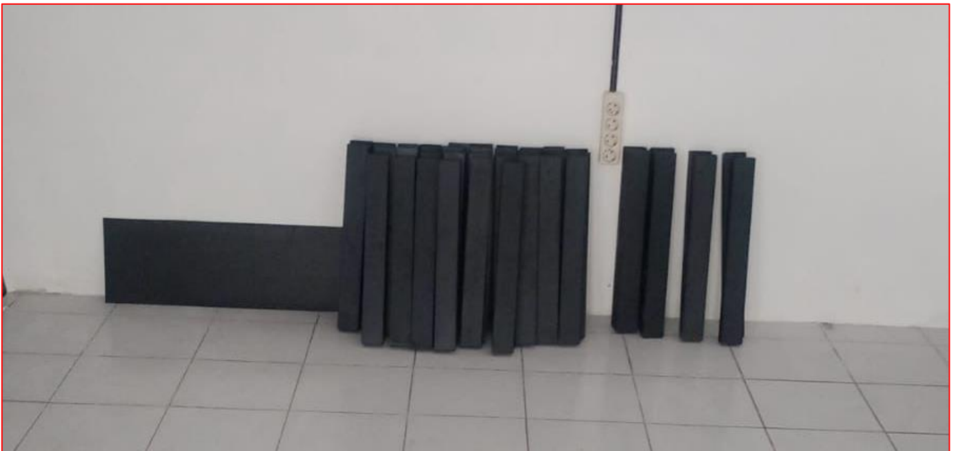
Gambar 11 Plat dan Balok sebagai Beban untuk Pengujian Jembatan
